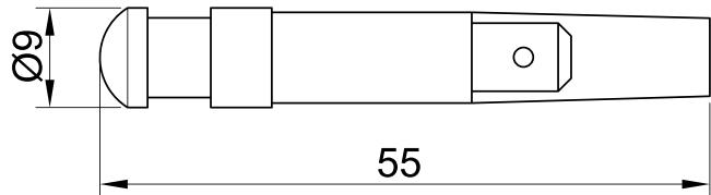
Segnalatore luminoso predisposto per accoppiamento con lente ad innesto laterale (tipo lente: G).
