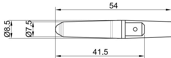
Segnalatore luminoso con lente conica per bloccaggio su foro diametro 10-12-13mm.
