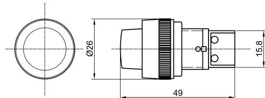
Segnalatore portalampada per attacco E10 e BA9S, le caratteristiche elettriche dipendono dalla lampada montata al suo interno.
