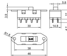
Commutatore a slitta a 3 posizioni con occhielli laterali di fissaggio.
