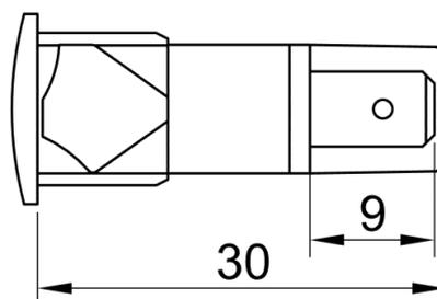
**Segnalatore luminoso a LED con innesto da fronte pannello autobloccante, con testa sottile (spessore 2,5mm)**
