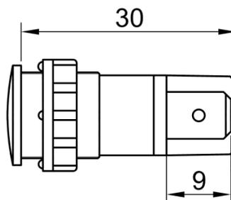
**Segnalatore luminoso a LED con innesto da fronte pannello, con testa sottile (spessore 2,5mm)**
